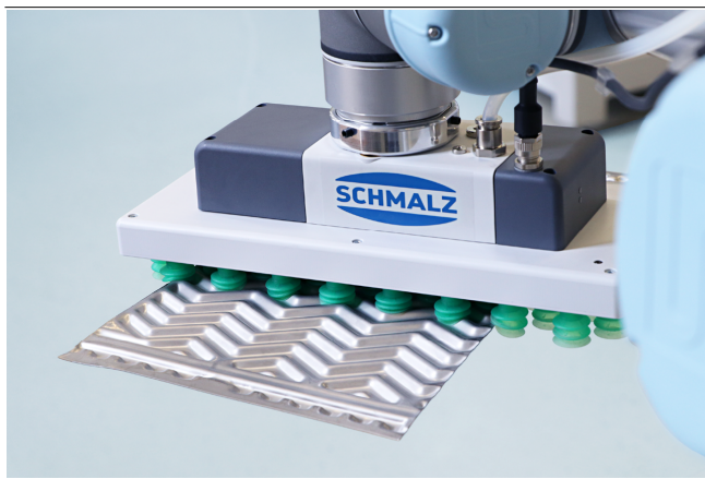
Sistema di presa ad area FQE Xc per la movimentazione delle lamiere
